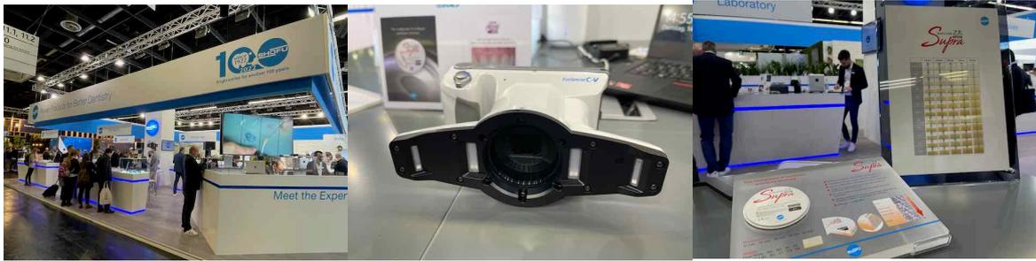
松風ブースで大きな注目を集めたのは人気口腔内カメラの最新機種『アイススペシャル C-V』です。従来品 C-IVは、速いシャッター速度や、被写体距離や背景の明るさに関わらず、被写体を常に一定の明るさで撮影できる機能、自動トリミングや、撮影時登録患者 ID で自動的にフォルダを分けて取り込める機能など、歯科に嬉しい機能が満載ですが、C-V では Wi-Fi 機能を本体に備え、タッチパネルの反応速度もよくなるなど、更に便利に進化しています。
