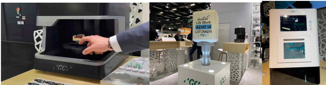
また、ラボ向けスキャナーは『ALS2+』『ALS3』と2機種を発表。ALS2+は精度 $4\mu\text{m}$ 、フルアーチスキャン速度18秒の製品。ALS3は精度 $4\mu\text{m}$ 、速度12秒の製品ですが、スキャナー本体内にプロジェクションマッピングのようにガイドや選択肢が表示され、同選択肢をクリックできるなど、使い勝手も向上。上下顎をスキャンすれば、咬合はソフトで自動的に作成してくれる機能などもあります。『ALS2+』『ALS3』のCADソフトは共にexocadベースのGC仕様で、サブスクのように毎月/毎年の料金は発生せず「買い切り」なことも魅力的な製品です。
